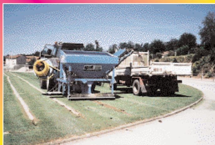
Un engin spécial pour poser en même temps drains et tuyaux d'arrosage.
